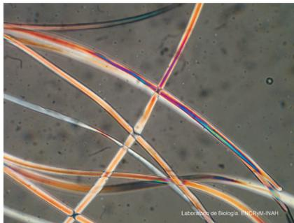
FIGURA 5. Hilos de seda (*Bombyx mori*) del damasco naranja; observación en microscopio óptico, 40x (Fotografía: Laboratorio de Biología ENCRyM-INAH, 2013; cortesía: STCRT, ENCRyM-INAH).
