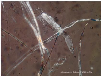
FIGURA 6. Fibras de pulpa de madera de angiosperma de los hilos de papel metalizado; observación en microscopio óptico, 40x (Fotografía: Laboratorio de Biología ENCRyM-INAH, 2013; cortesía STCRT, ENCRyM-INAH).
